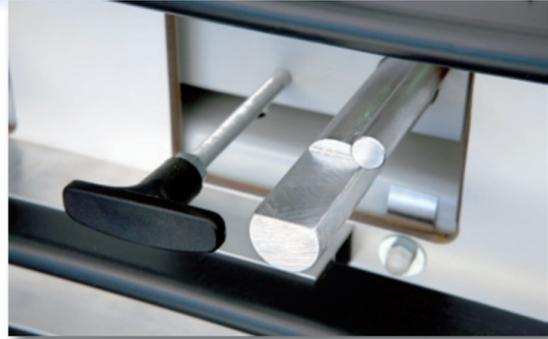
Аналогично нижней опоре, на средней опоре установлен упор. Упор предотвращает проскальзывание плиты при горизонтальном раскрое.
